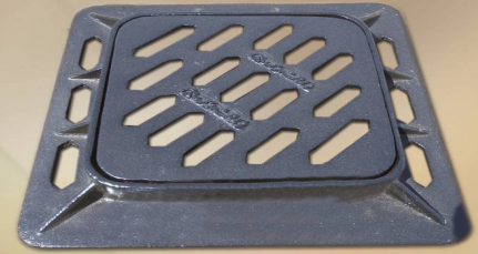
5 - 11 Grating and Frame size : 40x40 - 50x50 60x60 - 70x70 cm load : 1.5 tons to 90 tons أحمال من ١.٥ طن إلى ٩٠ طن غطاء صرف أمطار مقاس ٤٠ × ٤٠ سم ٥٠ × ٥٠ سم ، ٦٠ × ٦٠ سم ، ٧٠ × ٧٠ سم
