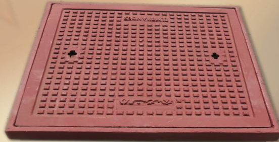
9 - 6 غطاء غرفة تفتيش مجوز مكون من ثلاث قطع وزن 125 كـ من الزهر الرمادي Square manhole cover Of 3 Parts ( Double Seal ) gray cast iron Size: 60 x 60 cm load : 125 kg
