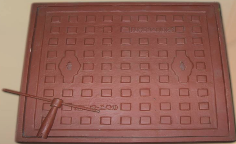
8 - 6 غطاء غرفة تفتيش مجوز مكون من ثلاث قطع وزن 70 كـ. 80 كـ. 90 كـ. 100 كـ. 125 كـ من الزهر الرمادي Square manhole cover Of 3 Parts ( Double Seal ) gray cast iron Size: 60 x 60 cm load : 70 - 80 - 90 - 100 - 125 kg
